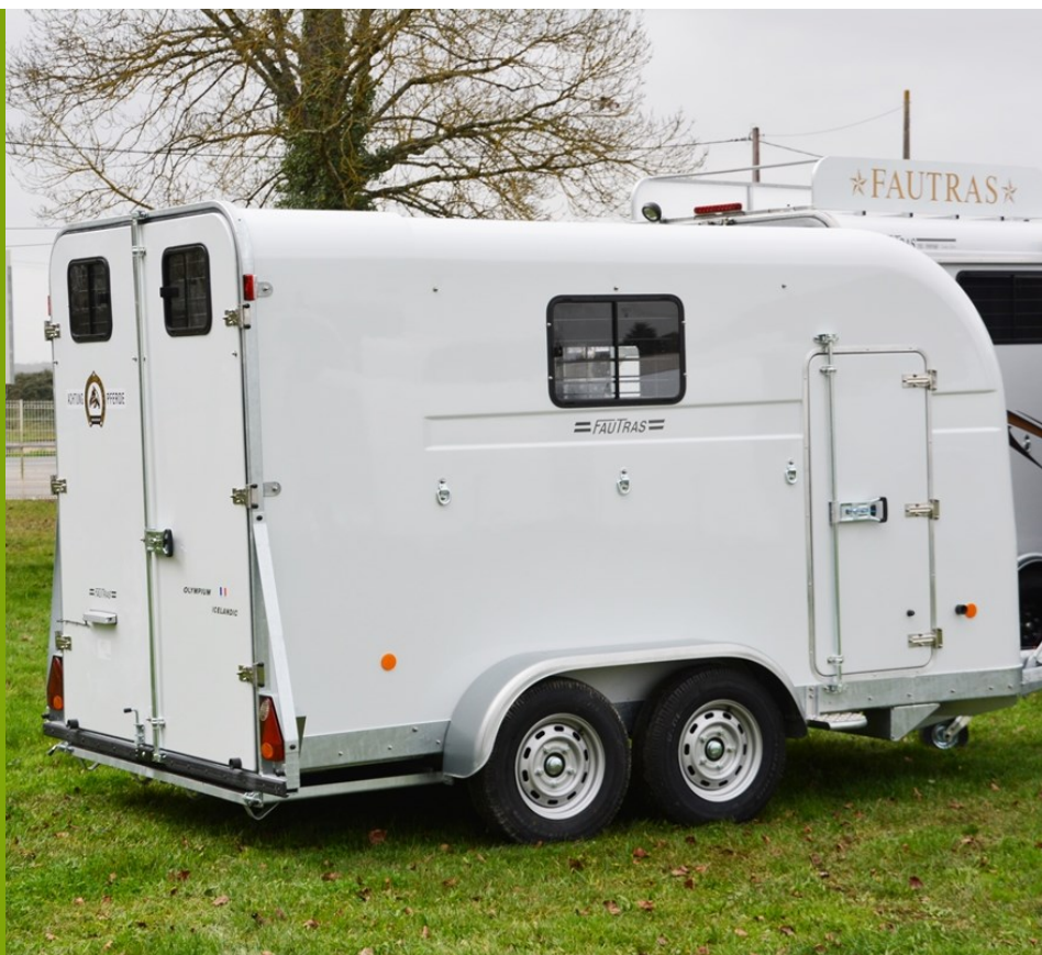
Containerstängning i rostfritt på både bakdörrar och sadelkammare.
